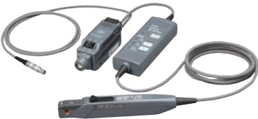
电流探头 0.5, 5, 30Arms, 702915 (DC ~ 50MHz), 702916 (DC ~ 120MHz)
